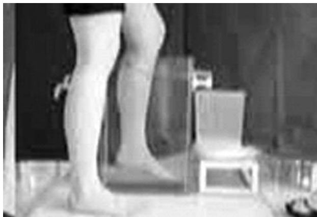
Figura 1 - Cuba de vidro com duas saídas, especialmente construída para realização de volumetria por deslocamento de água
