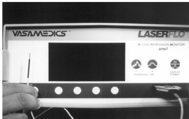
Figura 1 - *Laserflo® Blood Perfusion Monitor*: no canto inferior direito, observa-se a conexão entre o *probe* de fibras ópticas e o aparelho; no lado esquerdo, vê-se a ponta do *probe*
