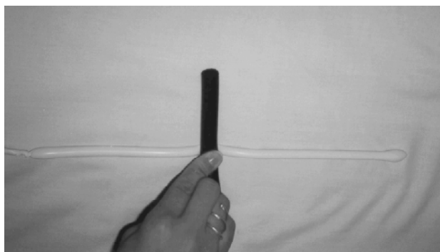
Figura 1 - Tubo com fluido em seu interior, o qual pode ser deslocado ao se deslizar um "rolete" sobre o conduto.
